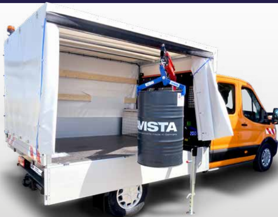
Ford Transit mit Pritsche, Plane- und Spriegelaufbau und Ladekran
